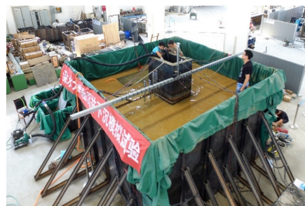
图 6 下沉模拟试验实拍
